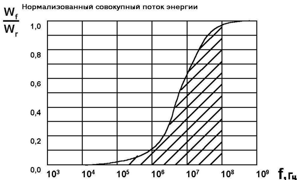
Рис. 1.7. Частотная зависимость нормализованного совокупного потока энергии от частоты
